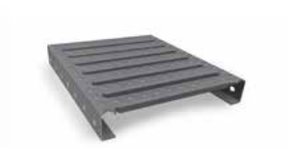
STEPPLUS N Rutschhemmende Oberfläche mit Reliefnoppen und nach unten ausgestanzten Schlitzern zur Verstärkung der Quersteife
