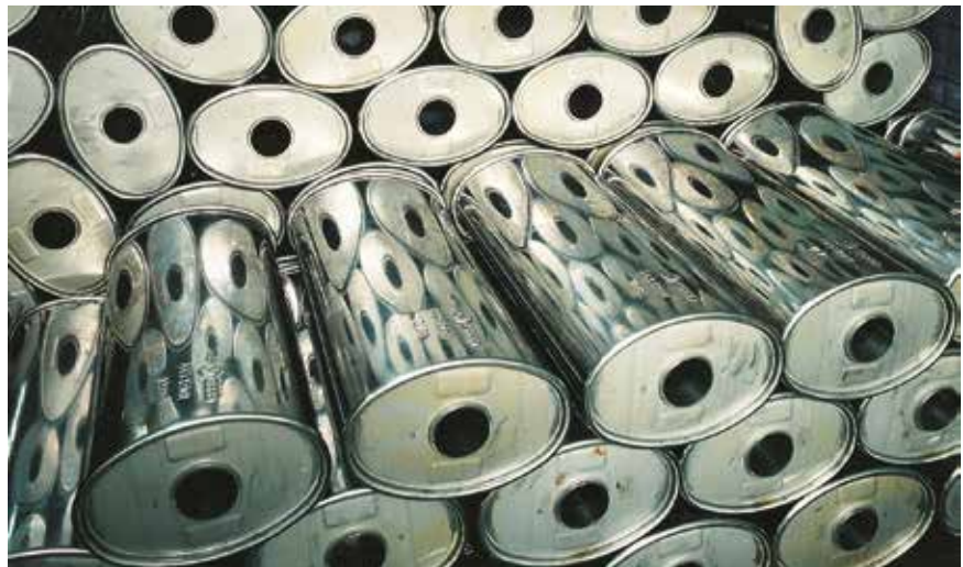
Bild 3: Auspuffanlagen – ein Einsatzgebiet von ferritischem korrosionsbeständigem Stahl im Automobilbau
