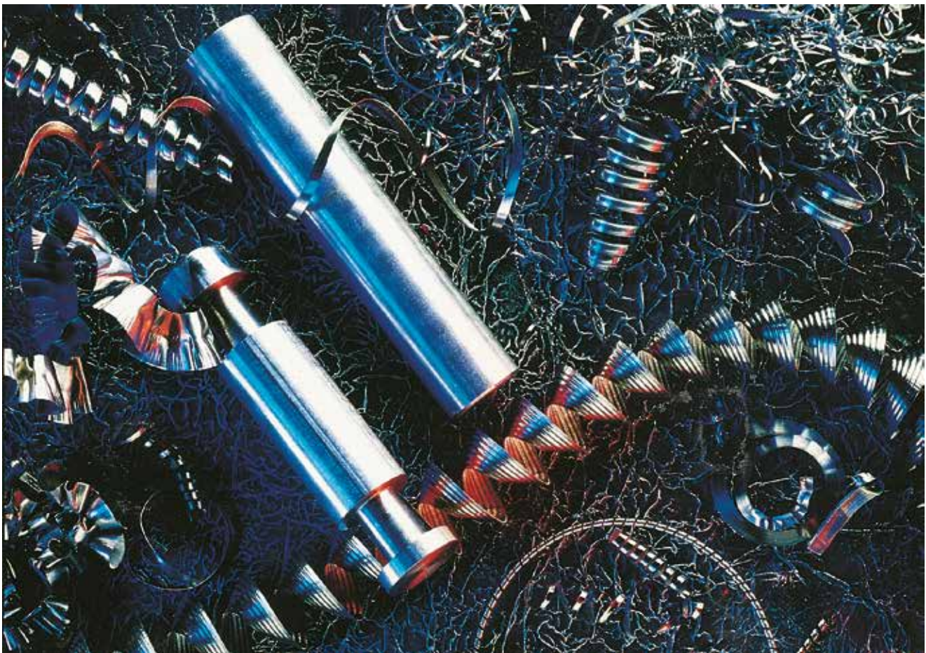
Bild 11: Beispiele von Spanausbildungen bei unterschiedlichen Schwefelgehalten
