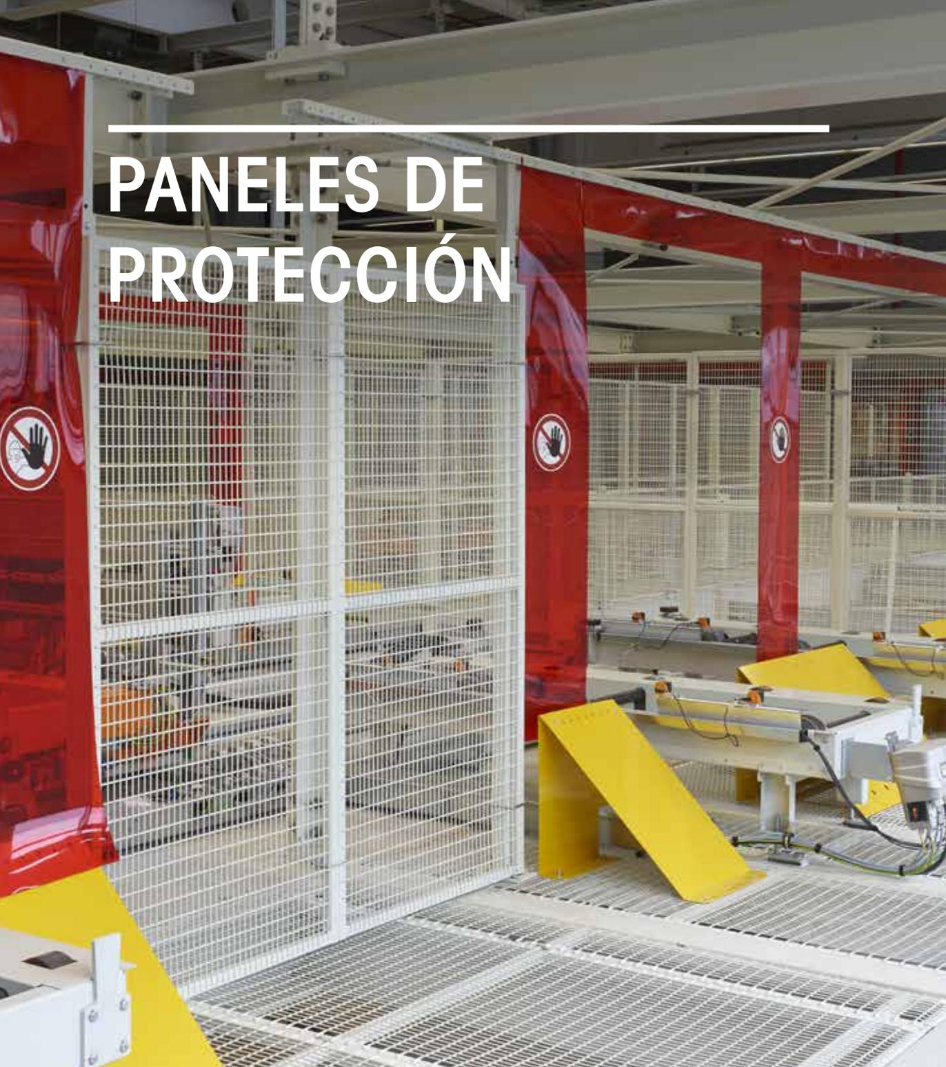
Los elementos de protección de anticaídas MEISER son la solución ideal para cubrir grandes superficies, como techos intermedios, para delimitar bordes de escenarios y para encerrar la tecnología de cintas transportadoras. Constan de un bastidor tubular portante y una rejilla de malla soldada. El tipo de bastidor tubular y el tamaño de la rejilla de malla suelen venir definidos por las normas de fábrica de cada fabricante de automóviles.
