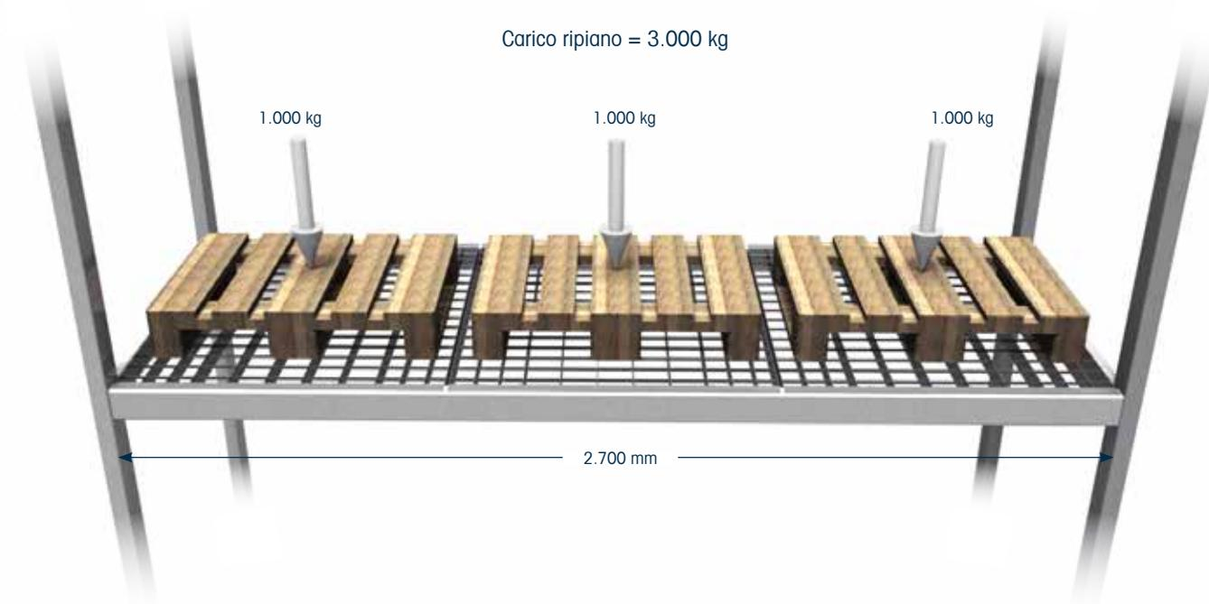
Esempi d'applicazione con 3 griglie Modulari MEISER, 995 x 890 mm, zincate a caldo, con un carico massimo di 1000 kg cad.
