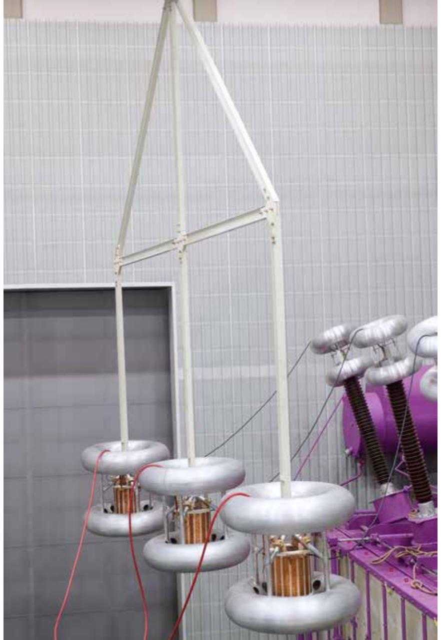
Hebmittel wie diese GFK-Konstruktion zeichnen sich auch unter Hochspannung aus
