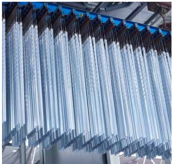
Der Verzinkungsprozess schützt Stahl dauerhaft vor Korrosion und Witterungseinflüssen
