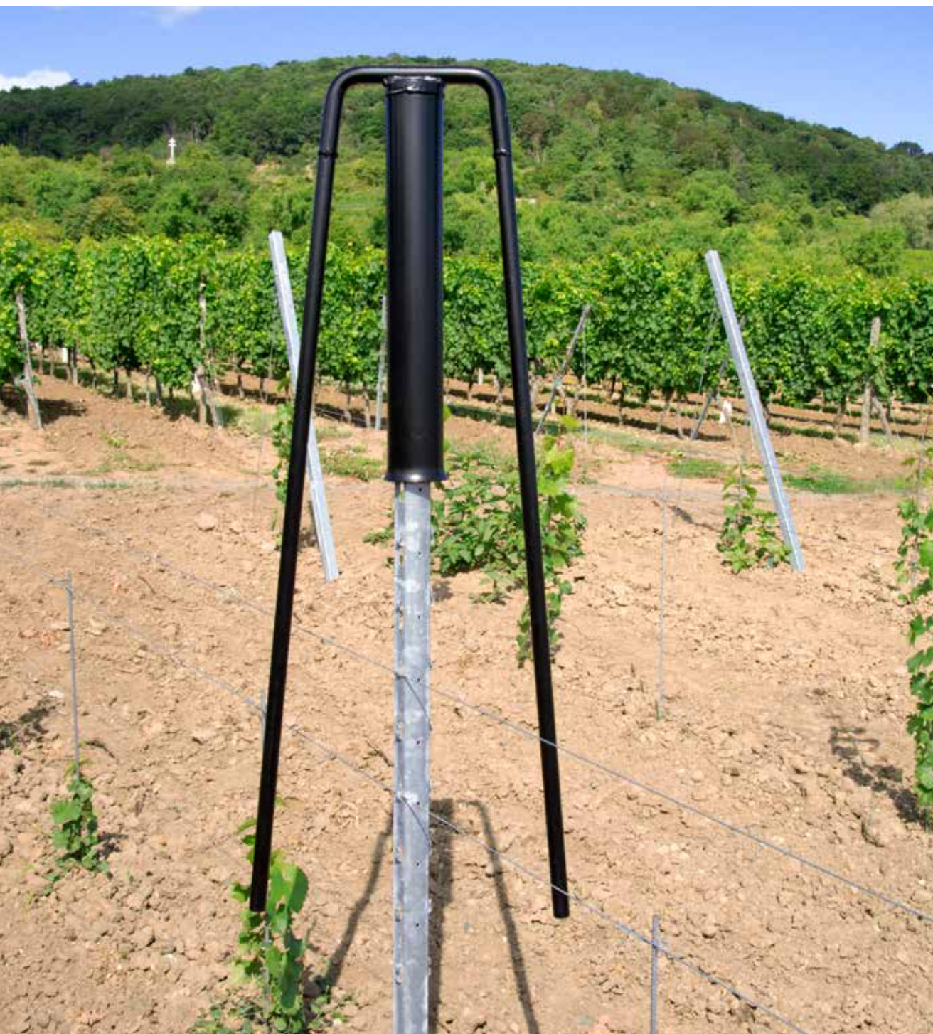
Große Handramme zum Einrammen von Pfählen mit einer Höhe von über 2,00 m
