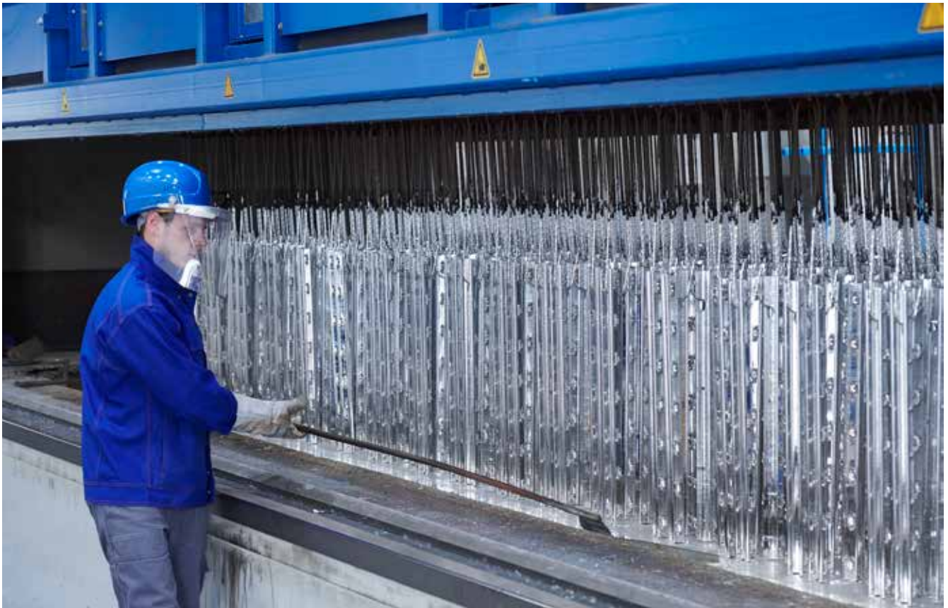
Ein Mitarbeiter entfernt Zinkasche von der Badoberfläche, um eine gleichbleibend hohe Beschichtungsqualität sicherzustellen
