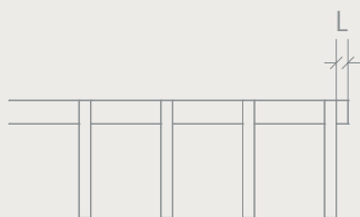
Barre insérante saillante et barre de bordure L max. = 0,5 mm
